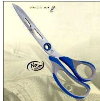
31478 FORBICI SARTORIA RING-LK 25,5cm 69171000 Forbice leggerissima di particolare pregio con lame particolarmente affilate fabbricate con acciaio inox AISI 420, impugnatura con Nylon 6 Metal-comma e tecnologia Ring-Lock che permette una regolazione precisa delle lame eliminandone il gioco, l'anello regolatore in Teflon
